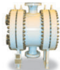
2-хступенчатый всасывающий охладитель (бессернистый природный газ) 2132 кВт, тип 7HH-256/1/1 с титановыми пластинами и корпусом из Duplex, 55-барная конструкция, работает на платформе по производству газа.
