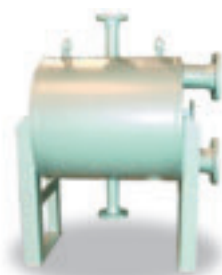
187 кВт, теплообменник триэтиленгликоль - насыщенный триэтиленгликоль, тип 5HH-220/1/1, корпус из Duplex, работает на платформе по производству газа.
