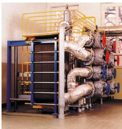
Данный тип теплообменников превосходит показатели теплопередачи кожухотрубчатых систем, значительно уступая им в цене. Также, при сравнении с кожухотрубчатыми теплообменниками, пластинчатые системы имеют более длительные интервалы между регламентными работами.
