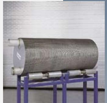
Сварной пластинчатый теплообменник VANTERUS состоит из корпуса круглого сечения и помещенной в него теплообменной кассеты. Соединение пластин в ТК\* производится автоматической лазерной сваркой. ТК\* помещается в специальный эластичный металлический корсет, обеспечивающий противодействие линейному расширению. Также этот корсет обеспечивает механическую поддержку ТК\* и направление потока первичного теплоносителя внутри корпуса.
